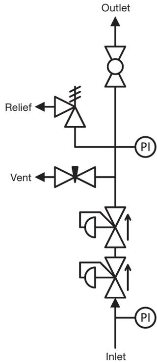
Fig. 12 Dual-Stage SGP P&ID
