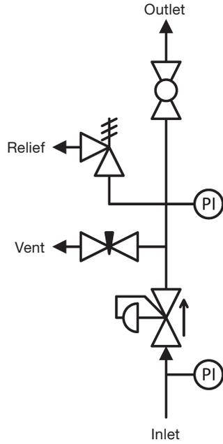
Fig. 11 Single-Stage SGP P&ID
